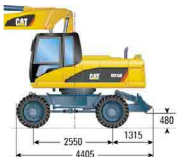
Unterwagen mit Abstütz-Planierschild
