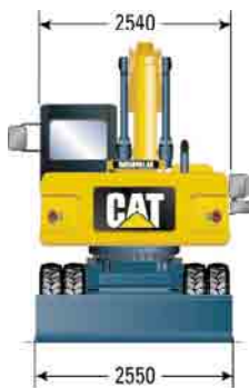
Unterwagen mit Abstütz-Planierschild
