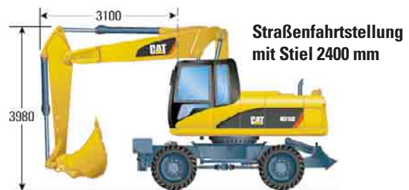
Unterwagen mit Kombiabstützung (Abstütz-Planierschild und zwei Abstützpratzen)
