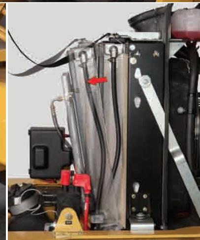
Der Zugang vom Boden aus, die Wartung von der rechten Maschinenseite sowie die Kontrollleuchten sind nur einige Gründe dafür, dass Cat-Maschinen im Vergleich zu Maschinen des Wettbewerbs einfacher und kostengünstiger zu warten sind. CS44 und CP44 verfügen zusätzlich über ein wartungsfreies Knickgelenk und einen kippbaren Ölkühler für einen besseren Zugang bei Wartungsarbeiten.
