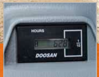
Betriebsstundenzähler (vom Boden aus ablesbar)
